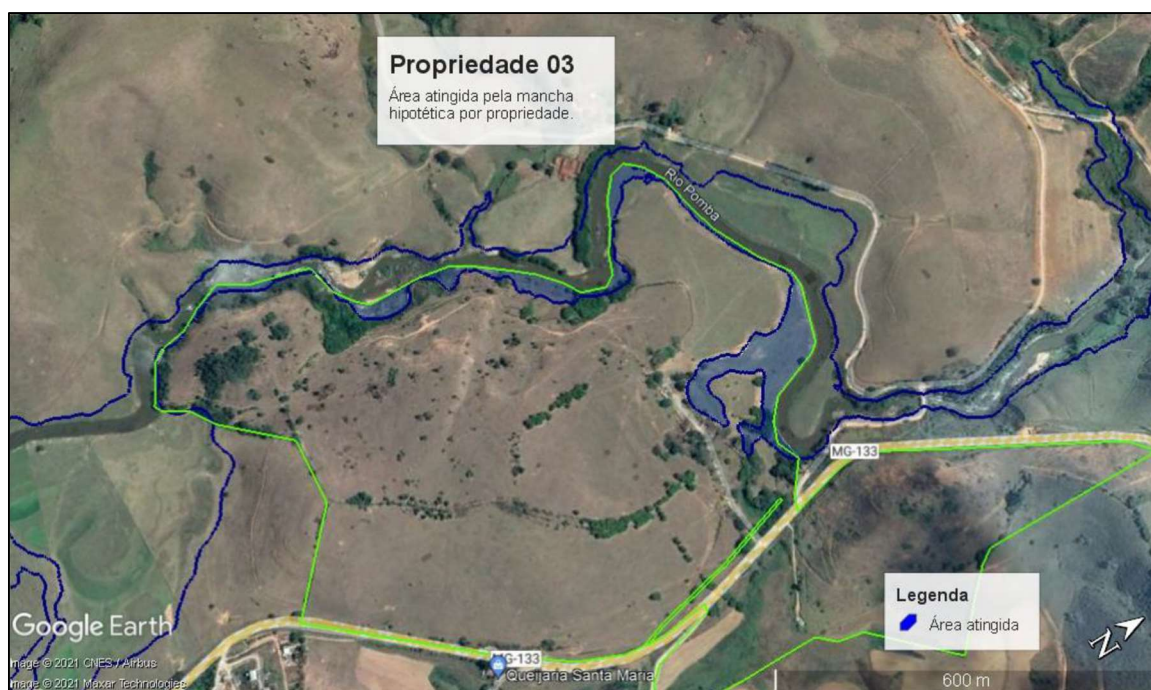
Figura 11.3 - Área da propriedade 03 atingida pela mancha de ruptura hipotética.
