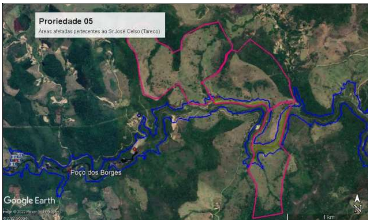
Figura 11.5 - Área da propriedade 05 atingida pela mancha de ruptura hipotética. Fonte: FUM-CAD-22-001, Hunos Consultoria, 2022.
