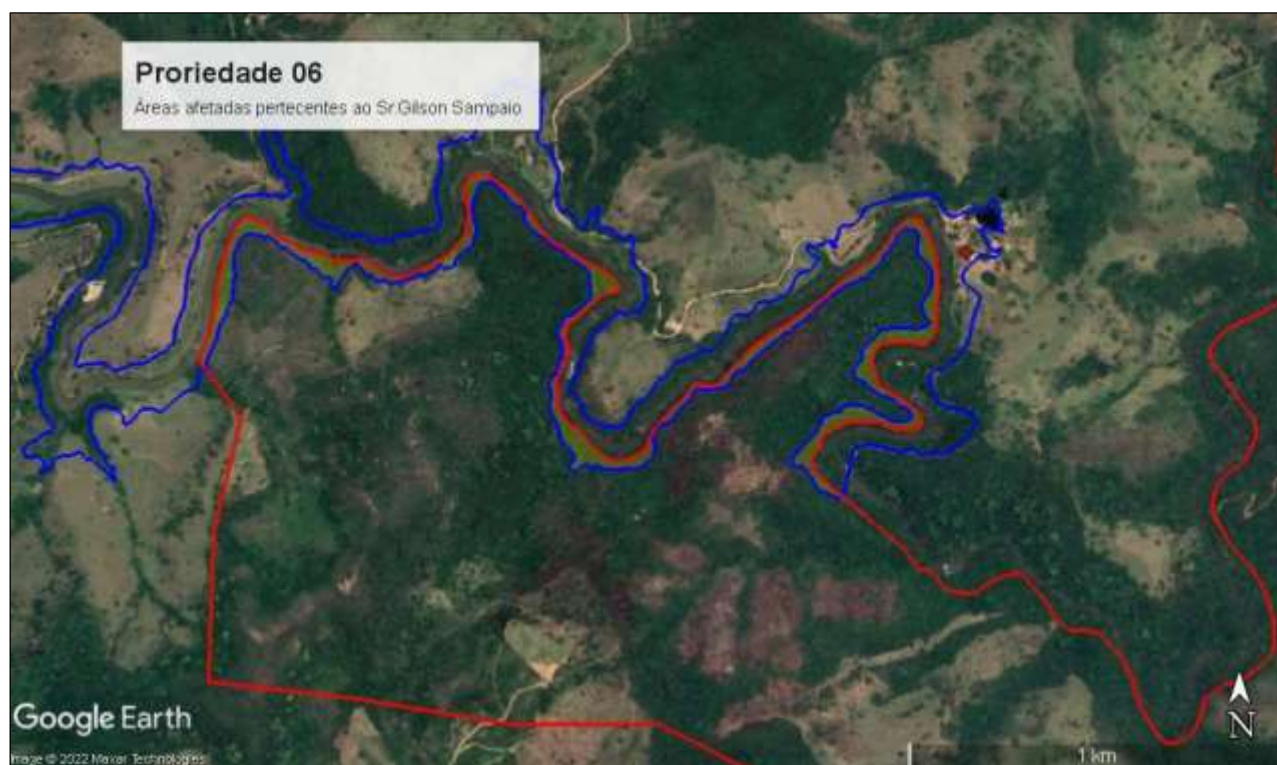
Figura 11.6 - Área da propriedade 06 atingida pela mancha de ruptura hipotética. Fonte: FUM-CAD-22-001, Hunos Consultoria, 2022.
