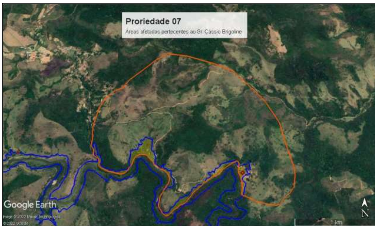
Figura 11.7 - Área da propriedade 07 atingida pela mancha de ruptura hipotética.
