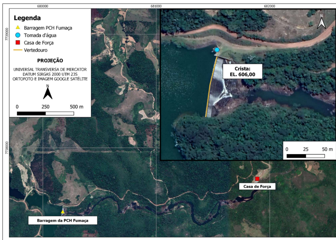
Figura 5.1 – Indicação das estruturas principais da PCH Fumaça.
