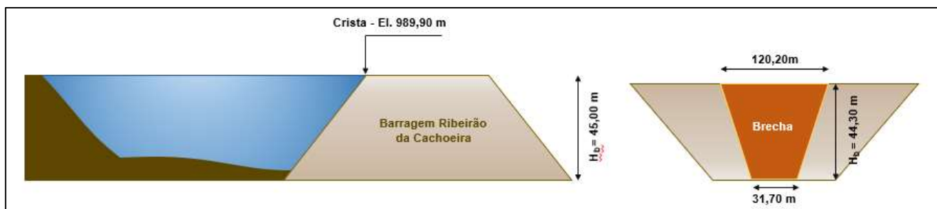
Figura 12.5 – Croqui da brecha no Maciço (sem escala).
